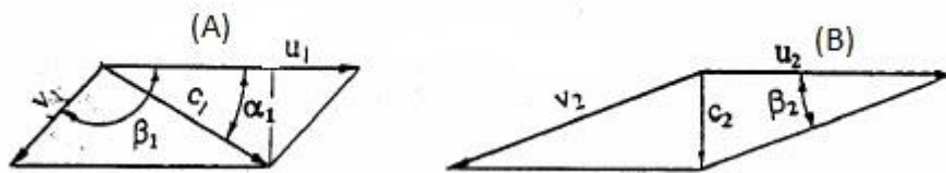
Figura 26- (A) Diagrama das componentes da velocidade de entrada. (B) Diagrama das componentes da velocidade de saída. Adaptado de [28].
